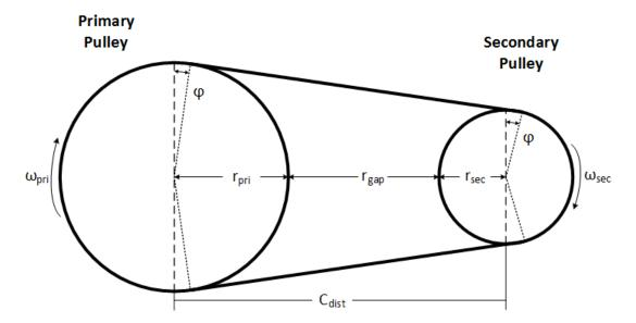
$$C_{dist} = rp_{max} + r_{gap} + r_{sec\_max}$$
